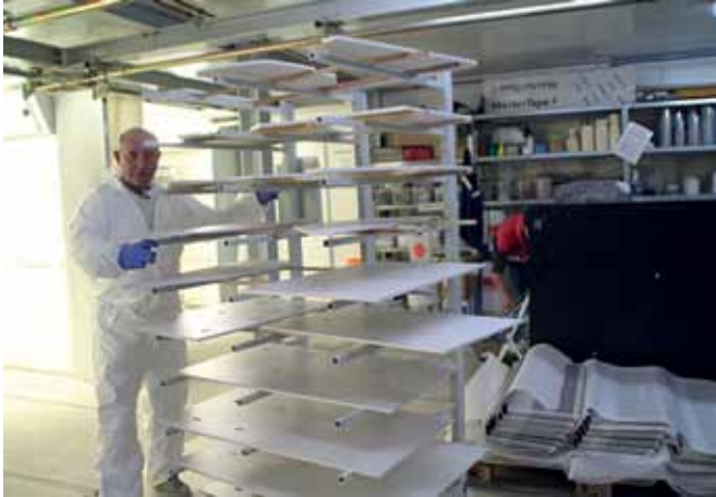
Linkes Foto: Der Mitarbeiter des Lackierzentrums Gert Lubik holt die frisch lackierten Flugzeugverkleidungen aus der Trocknung. Foto rechts: Bevor die Flugzeugteile ihre neue Oberfläche erhalten, bereitet David Häußler diese für die Lackierung vor.
