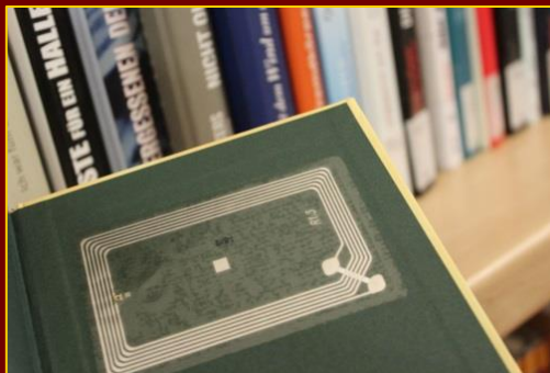
Ein Beispiel für einen im Buch angebrachten Transponder.
