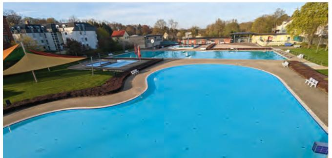
Das Freibad in Oberreichenbach wird mit ca. 3.000 m<sup>3</sup> frischem Quellwasser befüllt. Die Befüllung mit Frischwasser dauert in Abhängigkeit von der Ergiebigkeit der Quelle aus dem St. Georg Stollen ca. drei Wochen. Das Quellwasser hatte eine Temperatur von ca. 10 °C. Die Solaranlage auf dem Dach des Sanitärtrakts schafft bei Sonnenschein ca. 2 °C Wassererwärmung am Tag.
